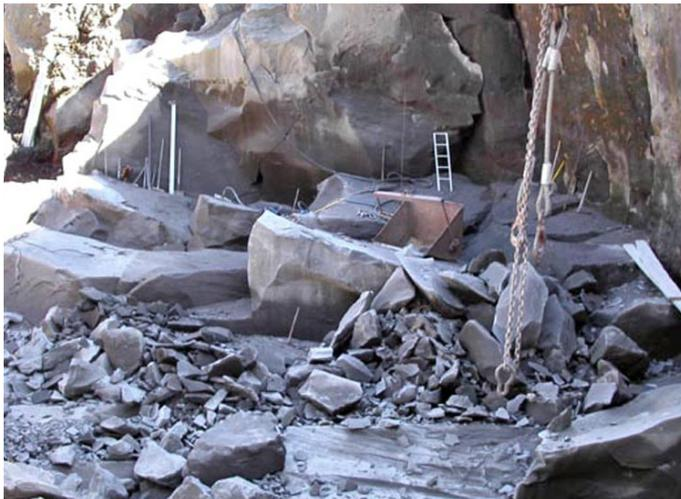
Des blocs de lave d'un poids allant jusqu'à 20 tonnes sont extraits à l'aide d'explosifs de carrières à ciel ouvert.
